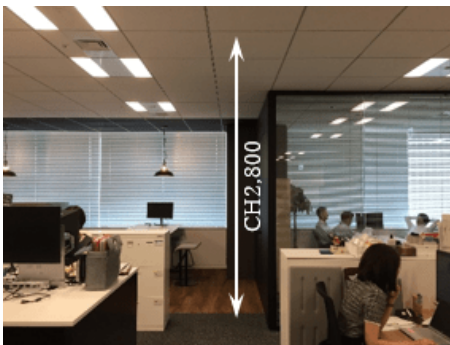
天井高さの確保、自動照度調整により快適な執務空間
