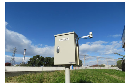
雨センサー付きの 灌水装置
